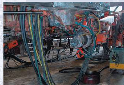
Bohrarm des Jumbos während der Revision
